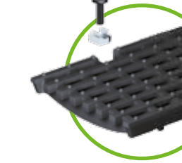
Litinový rošt s podélnou mřížkou MW 22/13 Tř. E - 4-násobné přišroubování je možné pouze do litinové hrany, pro NW 100 až 200
